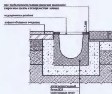
Схема устройства дождеприводника
